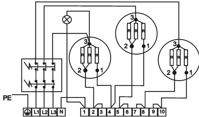
5kW 3 PE-N AC 400V / 50Hz
