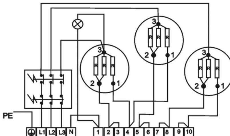
8kW 3 PE-N AC 400V / 50Hz
