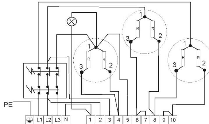
3kW 1 PE-N AC 230V / 50Hz
